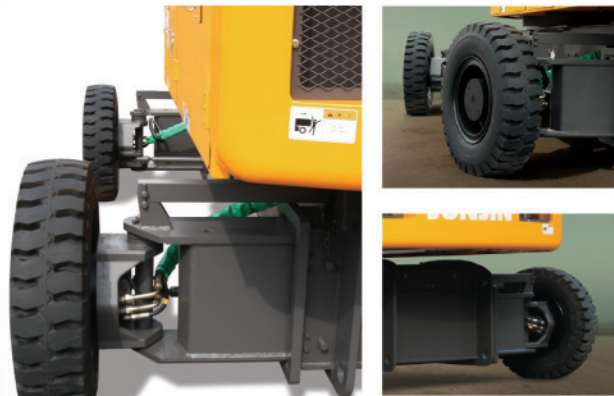
4x4x2, 4x4x4 주행시스템은 40%의 등판능력을 제공합니다. (옵선)
